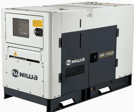
Generador trifásico Diésel Insonorizado, apto para exterior, con un panel inteligente que le permite revisar la corriente suministrada, horas de uso y autonomía. El equipo se puede arrancar de forma manual o automática mediante un tablero de transferencia, este esta incluido junto con el cable de conexión. Tiene 8 horas de autonomía.
