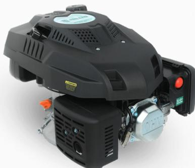
El modelo MVNW-201 pertenece a la línea de motores verticales náfteros, monocilíndrico, 4 tiempos, de la marca Niwa. Se destaca por su fácil arranque y bajo consumo de combustible. Sus características: 6.5 HP / 201 CC, válvulas a la cabeza (OVH) y un gran filtro de aire. Apto para 22 / 55,8 cm de corte. Ideal para motorizar nuestras cortadoras de césped Pampa Pro y otras similares. Mantenimiento de jardines y espacios verdes amplios.
