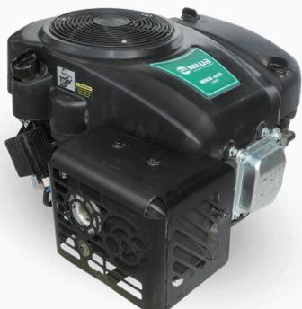
El modelo MVNW-449 pertenece a la línea de motores verticales náfteros, monocilíndrico, 4 tiempos, de la marca Niwa. Se destaca por su versatilidad en tractores cortacésped de baja potencia. Sus características: 14 HP / 449 CC y válvulas a la cabeza (OVH). Apto para 42 / 106,6 cm de corte. Ideal para motorizar minitractores corta de césped. Mantenimiento de jardines amplios, quintas, parques, pequeños clubes, etc.
