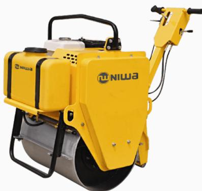
Rodillo compactador simple Niwa Roadway Motor HONDA GX160 5,5 HP. Peso: 283 kg. Conducción: Manejo hidráulico estático. Ancho rodillo del. 600 mm. Diam. 450 mm. Frecuencia 70 Hz. Fuerza Centrifuga Max 15 kN. Vel. de desplazamiento:0 - 2,8 km/h.
