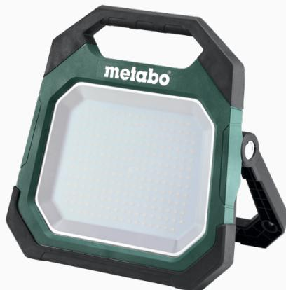
Proyector LED de luz blanca para obra a batería de 18 V, con 10000 lúmenes que brinda una luz de trabajo uniforme. Posee imanes integrados para una fijación rápida sobre superficies metálicas. IP 54. Preparado para colocar en trípode. Cabezal de lámpara giratoria 270°. Entrada USB para carga de dispositivos (salida de corriente 1 Ah). Utiliza 2,5 horas a la máxima potencia con una batería de 10 Ah. Se puede conectar a red y utilizarlo en forma continua.
