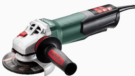
Amoladora de 1700 W para uso industrial con disco de 125 mm, con sistema quick para cambio rápido de disco y guarda ajustable sin necesidad de herramienta. Por su bajo peso y su gran potencia se recomienda para trabajo sobre cabeza. Su Motor Marathon brinda mayor potencia con un torque elevado y un 20 % mas de vida útil. con embrague mecánico, arranque suave, gatillo tipo paleta, seguro contra arranque involuntario, y sistema TC que mantiene las revoluciones constantes cuando aumenta la carga.
