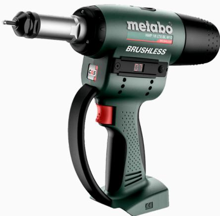
Colocadora de tuercas y tornillos remachables de aluminio, acero carbón o acero inoxidable, a batería de 18 V con motor Brushless. Cuenta con control de torque digital ajustable en función del diámetro y la dureza del material. La capacidad máxima para tuercas o tornillos de AL M10, AC M8, Inox M6. Posee luz Led de trabajo integrada, además un recipiente contenedor de boquillas. Incluye Maletín Metabox 145 L
