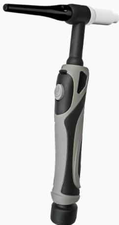
Torcha TIG de 150 amp tipo WP 17, con mango ergonómico y pulsador incorporado, 4 metros de largo. Ficha con de 12 pin de conexión. Para soldadora Niwa TIG 200 AC/DC Pulse y Multimig 180 EX.
