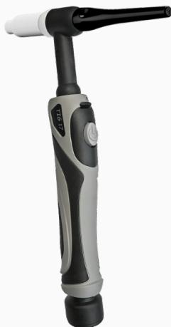
Torcha TIG de 150 amp tipo WP 17, con mango ergonómico y pulsador incorporado, 4 metros de largo. Ficha con de 9 pin de conexión. Para soldadora Niwa Multimig 200 EX.
