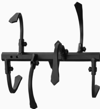
Un accesorio de azada profunda, con curvas tanto a la izquierda como a la derecha, que permite preparar suelos más duros en condiciones difíciles. Afloja eficazmente el suelo denso sin mezclarlo excesivamente, lo que lo hace ideal para suelos propensos a la erosión o compactados. Ancho de trabajo: 470 mm Profundidad de trabajo: 210 mm.
