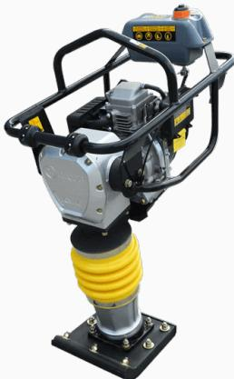
La maquina mas vendida para obras de construcción. Este económico y confiable moto pisón con motor Niwa de 4,0 HP, es la herramienta de compactación más usada en la compactación de suelos. Su motor específico de motopisón (no es el clásico motor estacionario que derrama combustible), es fácilmente reparable. Esto junto al pie de aluminio y su rendimiento en obra, lo hacen la primera opción a la hora de elegir.
