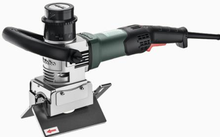
Perfecta para biseles de hasta 15 mm. Ajuste de profundidad sin herramientas en pasos de 0,1 mm. Cabezal con placas reversibles para ángulos de 0 a 90°. Tope de guía para resultados uniformes y rollo tope para tubos. Motor Marathon con protección contra el polvo. Electrónica VTC para revoluciones constantes bajo carga. Diseño delgado y chapas laterales para desviar virutas. Incluye metaBOX para transporte y almacenamiento.
