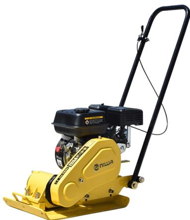
Esta plancha compactadora de 60 kg con el eficiente y confiable motor Honda GX160 5.5 HP, es ideal para trabajos pequeños de compactación hasta 0,20 m de espesor de suelo. De 0,36 m de ancho, puede utilizarse para compactar encadenados o cimentaciones corridas.
