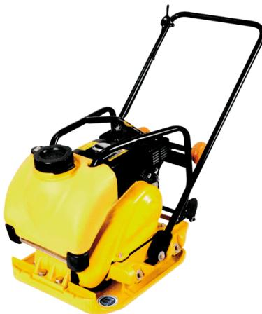
El motor Honda de 5,5 HP hace de esta plancha compactadora con tanque de agua de 97 kg una excelente opción para trabajos de bacheo en pavimentos de asfalto, así como para trabajos de compactación hasta 0,30 m de espesor de suelo. Puede usarse en zanjas de 0,50 m de ancho.
