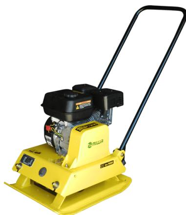
El motor Honda de 5,5 HP le confiere a esta plancha compactadora de 95 kg confiabilidad y rendimiento. Es indicada para trabajos medianos de compactación de capas de suelo hasta 0,30 m
