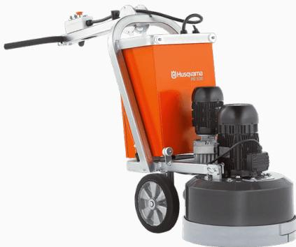
La PG 530 es una pulidora semi profesional monofásica de 530 mm de diámetro y dos motores, de alta capacidad para propósitos residenciales y comercial liviano. Sistema planetario de tres cabezales, con control de velocidad e inversión de giro. Excelente para la remoción, preparación, reparación y pulido a espejo de pisos de hormigón HiPERFLOOR® de Husqvarna. Indicada para superficies mayores a 500 m<sup>2</sup>. Para un resultado óptimo se recomienda el uso con la aspiradora Husqvarna DC 3300.
