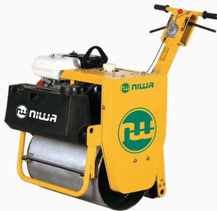
Este rodillo vibratorio de 266 kg de peso con tanque de agua, tiene un motor de 6,5 HP y avance hidráulico (el operador camina detrás). Específico para suelos y pavimentos (tiene tanque de agua), puede trabajar en pendientes de hasta 30% y en zanjas de 0,70 m de ancho
