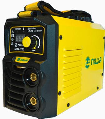
MMA-200 es un equipo para uso profesional, muy compacto y liviano. Cuenta con una correa que facilita su traslado. Su display digital permite ver la corriente real de soldadura, ideal para todo tipo de trabajo de soldadura. No necesita ser regulada, coloca el electrodo, selecciona el amperaje según el diámetro de electrodo y espesor a soldar y listo, inicia el arco con solo apoyar y separar.
