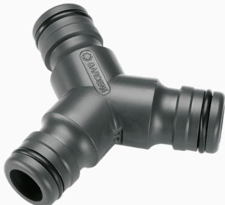
Adaptador ideal para derivación triple de gran caudal Profi system. Se utiliza para la unión rápida de 2 tramos de manguera, a otro tramo inicial obteniendo una bifurcación. Para pasar de una entrada de 3/4" a 2 salidas de 3/4".
