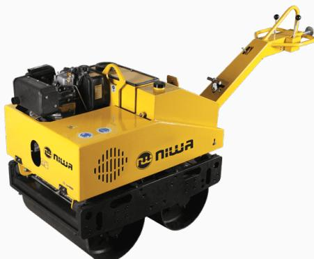
RODILLO COMPACTADOR NIWA ROLNW-643, un rodillo vibratorio DOBLE de 580 kg de peso y motor de 13.0 HP Niwa, para compactar suelo y concreto asfáltico. Los dos rodillos traccionan, los dos rodillos vibran. Un concepto económico y práctico, con arranque eléctrico, fácil de operar y de muy eficiente compactación. Trabaja en pendientes de hasta 30%. Además, posee un sistema de amortiguación de las vibraciones que aisla al operario de las mismas, para que la condición de trabajo sea la adecuada.
