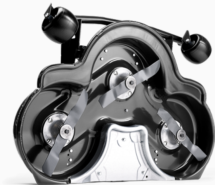
Plataforma de corte para Rider Husqvarna modelo R316TX de 94 cm de ancho.
