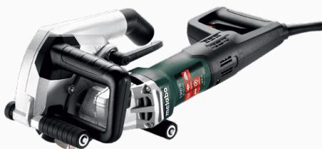
Acanaladora para pared MFE 40 Metabo, ideal para la realización de instalaciones eléctricas que precisan tender cables y tubos vacíos detrás del revoque con profundidades de fresado de hasta 40 mm. Se puede utilizar en disco diamantado de 2 o 3 filas con un ahorro de hasta 50% del tiempo, muy fácil de utilizar en trabajo horizontal o vertical. Posee conexión universal para aspiración de polvo.
