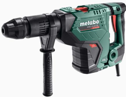
Este martillo combinado con dos funciones, cincelar y perforar con golpe. Con tecnología brushless (motor sin escobillas) que proporciona alto nivel de potencia y avance de taladrado y aumenta su vida útil, Vibratech (para disminuir las vibraciones), electrónica de onda plena (para adecuar las revoluciones al material) y embrague de seguridad S-automatic.
